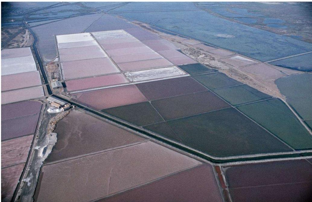
*Figure 3 - Salines de Santa-Pola (Espagne) ; l'eau de mer passe par des bassins où se déposent les carbonates (calcaire et dolomie) puis le gypse (teinte vert foncé - brun) avant d'aboutir sur les « tables salantes » où les saumures très concentrées sont marquées*
