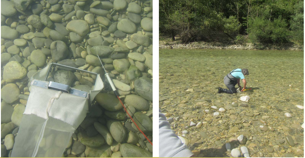
Prélèvements d'invertébrés au filet surber dans un plat courant de la station Estellier
