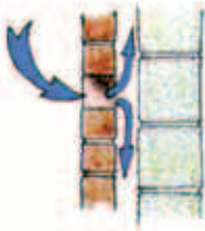
Accès par un joint resté ouvert dans le mur de parement
