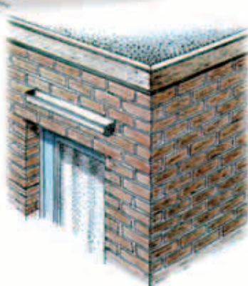
Placement d'une gouttière
