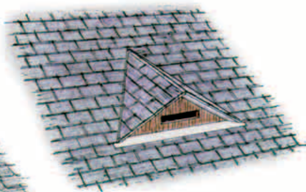
Vitrage remplacé par un panneau avec ouverture adaptée
