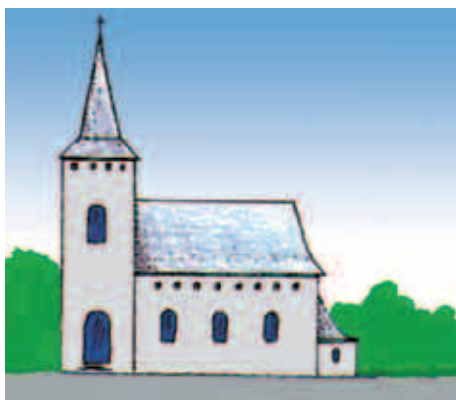
Emplacement des trous de boulin
