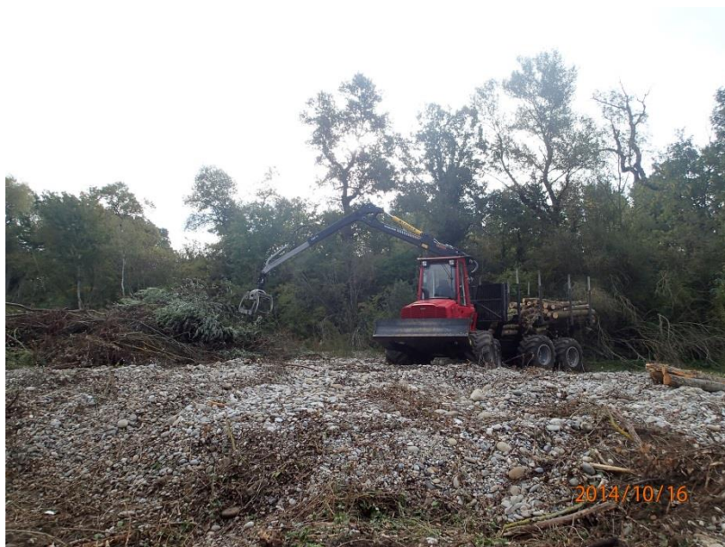
Photo de vidange des bois par un porteur forestier Gréoux-les-Bains - Guillaume RUIZ
