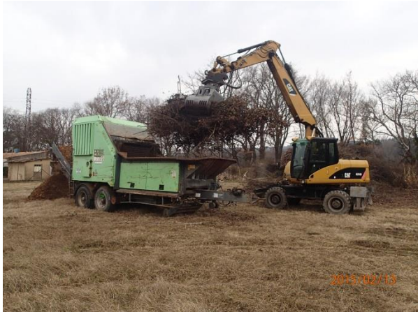
Photos de broyage des rémanents issus des travaux rivière – Guillaume RUIZ
