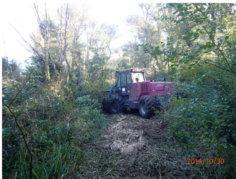
Photo de broyage d'un layon avec un broyeur forestier à Vinon-sur-Verdon - Guillaume RUIZ
