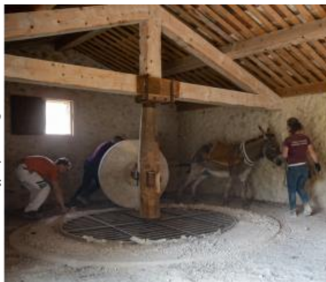
Broyage du plâtre
