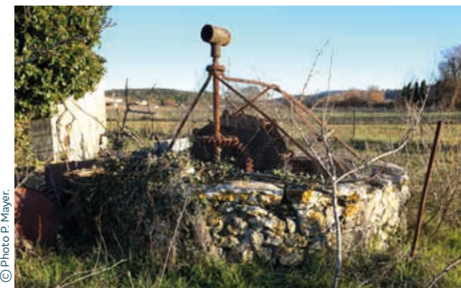
Noria à Saint-Julien-le-Montagnier. L'axe central est actionné par la traction animale, le système élève l'eau à l'aide d'une chaîne sans fin munie de godets qui puisent l'eau dans le puits.
