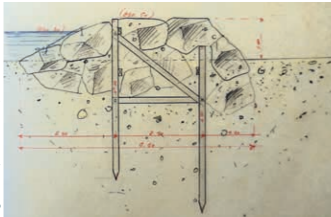
Profil d'une digue avec pieux, 1907.
